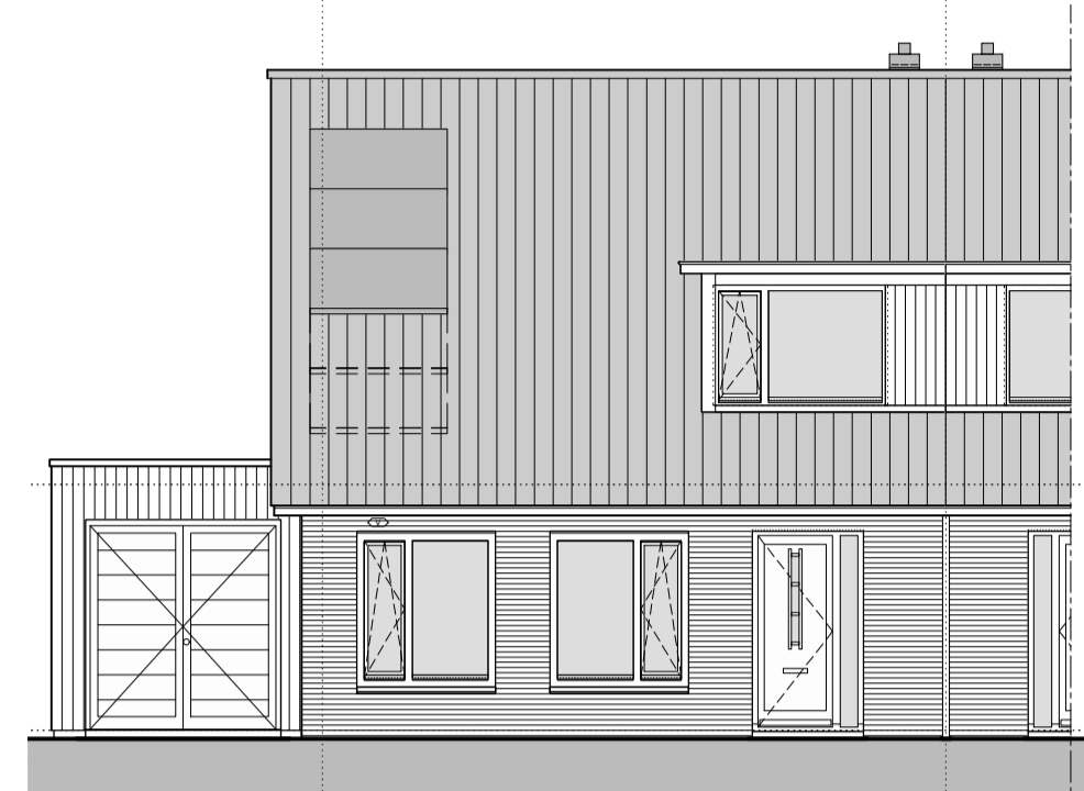
gevelaanzicht voorgevel type Dx dubbele deur berging
