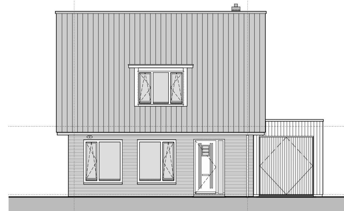
gevelaanzicht voorgevel type F optie dakkapel
